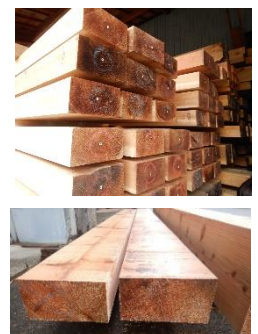
図4 解説書と製材された心去り材(平角)
